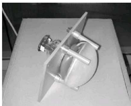
Rysunek 2.6: Fotografia fotopowielacza służącego do rejestracji światła scyntylacyjnego w detektorze T600 [23].
